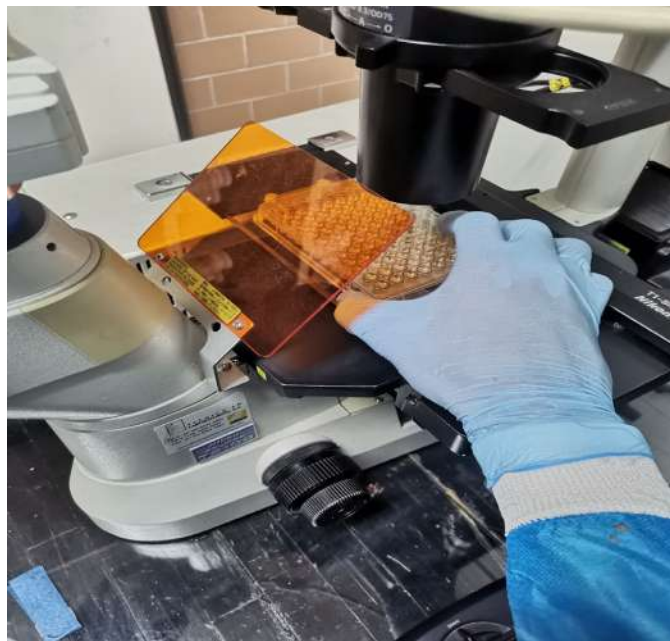
Figura 3. Observación de línea celular en microscopio invertido de contraste de fases T100. Imagen tomada por el autor en el cuarto de cultivo celular EHNM-IPN.
